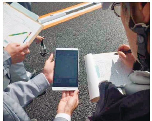
TSとタブレットPCによる現地検査(任意箇所)
