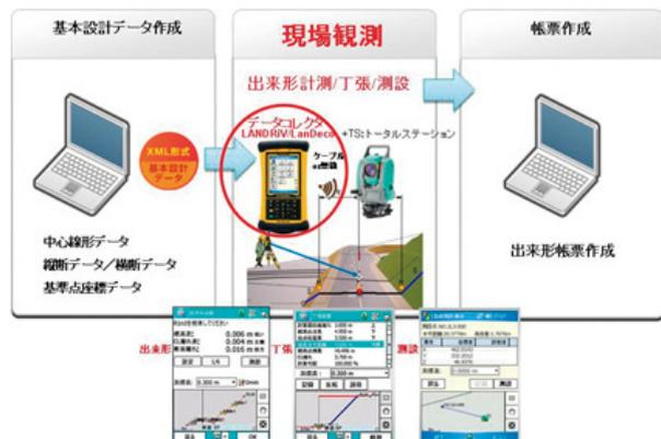
写真-3 土木施工支援システム（システム概要図）
