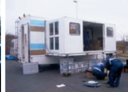
災対本部車を拡幅し作業場所確保
