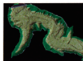
レーザー計とナローマルチビームを用いたダム貯水池地形調査
