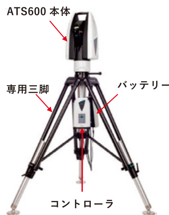
写真1 ATS600の機器構成
