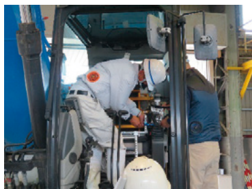
写真-1 遠隔操縦装置取付（操縦席）
